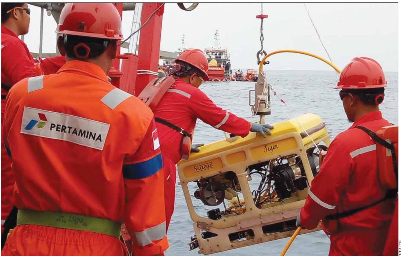
PHE ONWJ secara aktif memberikan dukungan dalam pencarian badan pesawat Lion Air JT-610 dengan menggunakan alat sonar pendeteksi bawah laut dari kapal Dunamos dan penggunaan Remote Operated Vehicle (ROV) dari kapal Victory. ROV adalah alat yang digunakan untuk mencari keberadaan lokasi badan pesawat di bawah laut. Sebanyak lima kapal dari PHE ONWJ membantu Basarnas untuk menemukan korban jatuhnya pesawat di perairan Tanjung Karawang.
