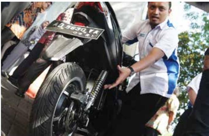
**SOLO** - Seorang pekerja dari UNS sedang melakukan uji coba menggunakan sumber tenaga Lithium Ion Battery Pertamina - UNS di motor listrik buatan UNS.
