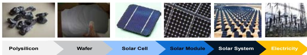
Polysilicon adalah komponen pembentuk *solar wafer*. *Polysilicon* berasal dari pasir kuarsa yang melewati proses kimiawi menjadi produk yang dapat dijadikan bahan baku *solar wafer*. Selain untuk industri *solar cell*, *Polysilicon* digunakan dalam industri semi-konduktor. Hingga tahun 1995 ketika kebutuhan *polysilicon* untuk *solar cell* masih rendah kapasitas produksi *polysilicon* tersedia cukup untuk melayani permintaan industri semi-konduktor.
