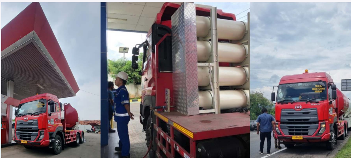
Gambar Pengisian CNG ke DDF truk dan pengujian road test rute Purwakarta-Cileunyi
