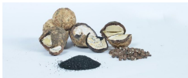
Cangkang kemiri yang sudah di crusher dengan ukuran 10-20 mesh dan dapat juga dijadikan karbon aktif sebagai added value
