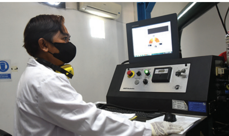
Pengecekan Nilai Oktan BBM dengan mesin Cooperative Fuel Research (CFR) di Laboratorium, Fuel Terminal Plumpang, Jakarta.
