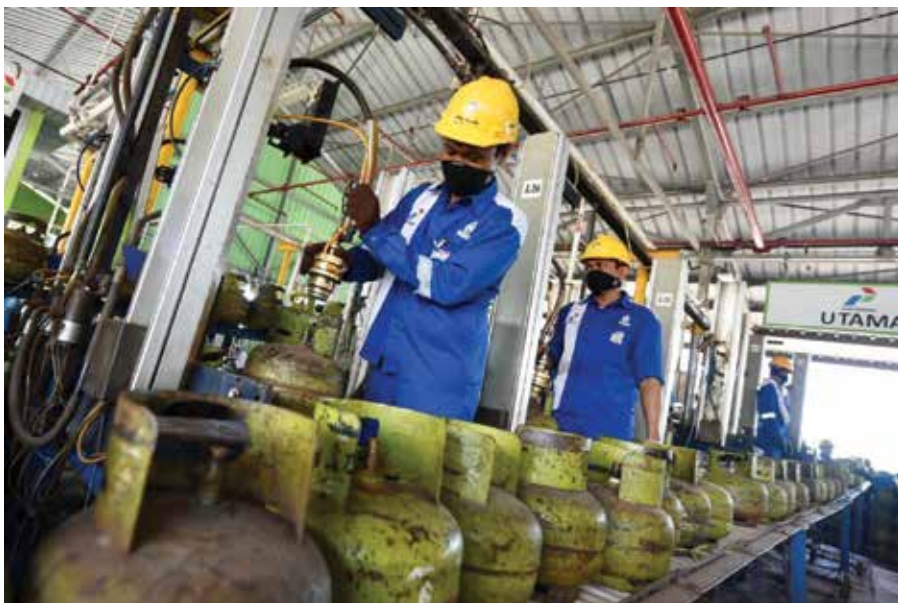
Petugas melakukan pengisian gas ke dalam tabung LPG 3 Kg di Stasiun Pengisian Bahan bakar Elpiji (SPBE) di kawasan Terminal LPG Makassar.
