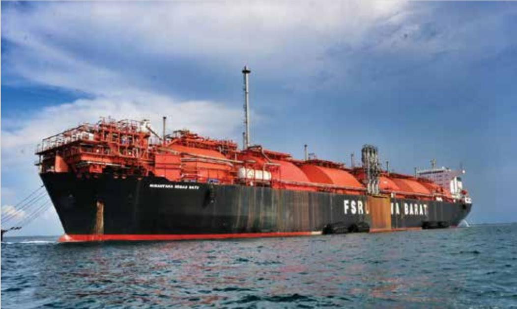
IP Tanjung Priuk dan PJB Muara Tawar. Pasokan Gas FSRU didapatkan dari Kilang LNG Bontang dan Tangguh LNG dengan suhu minus 160 C yang dibawa dengan kapal LNG untuk kemudian disimpan dalam FSRU dan diregasifikasi dengan media Propane sampai menjadi gas.
