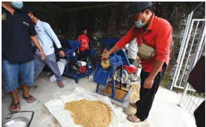
Proses pengolahan pakan ternak burung berupa pelet dengan bahan dasar cangkang kepiting menggunakan mesin pembuatan pakan ternak yang diberikan oleh Pertamina.
