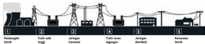
GAMBAR 5. Ilustrasi pengoperasian teknologi listrik arus bolak-balik
