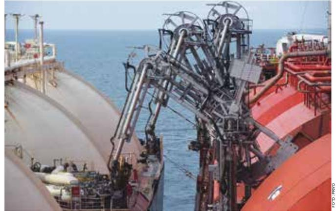
Sejumlah pekerja melakukan pengecekan saat proses *loading transfer* LNG dari kapal Aquarius ke FSRU Nusantara Regas di Kepulauan Seribu, (4/1/2018).
